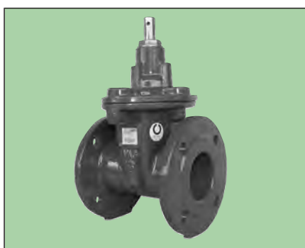
VAG BETA® 300 Absperrschieber ANSI Wasser PN 16 - DN 50...400 weichdichtend - Wasser
