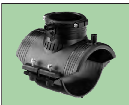
Aufschweißsattel Wasser PN 16 - DN 50...300
