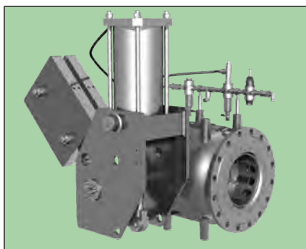
VAG RIKO® Ringkolbenventil mit Eigenmediumsteuerung als Druckminderventil Wasser PN 10/16 - DN 150...1000
