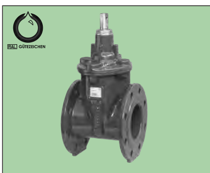
VAG BETA® 300 Absperrschieber Seewasser PN 10/16 - DN 40...600 weichdichtend - kurze Baulänge
