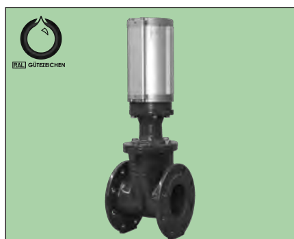
VAG BETA® 300 Absperrschieber mit Pneumatiktrieb Wasser, Abwasser PN 10 - DN 40...300 weichdichtend - kurze Baulänge
