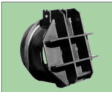
VAG HADE Rückstauklappe PTK-BS Abwasser PN 0,5 - DN 300...1000 Schrägsitz für Freispiegelleitungen zum Einschleiben in Beton-Rohre
