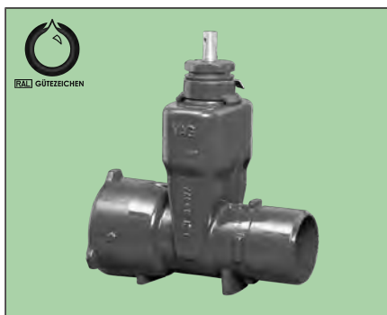
VAG BETA® 200 Absperrschieber MU/SP Wasser PN 16 - DN 80...300 für VAG BAIO®plus System
