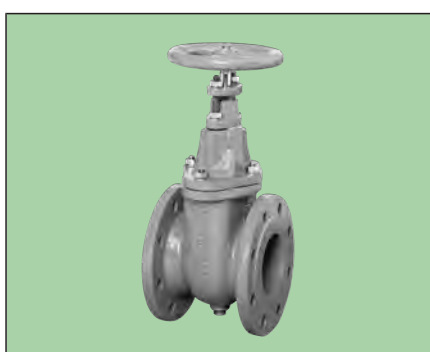
VAG KFS Keilflachschieber mit innenliegender Spindel Abwasser PN 1/1,6/2,5/4/6/10 - DN 50...1200 metallischdichtend - kurze Baulänge - mit Handrad
