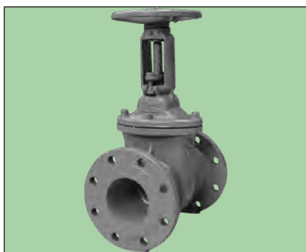
VAG IKO®plus Absperrschieber mit außenliegender Spindel Wasser PN 16 - DN 40...300 metallischdichtend - lange Baulänge - Edelstahl - mit Handrad
