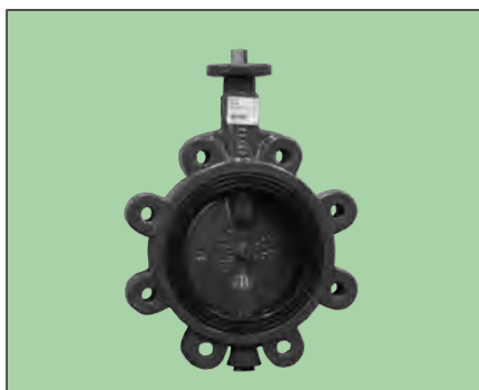
VAG CEREX® 300-L Absperrklappe Gas PN 10/16 - DN 50...300 Klappenscheibe Guss - Lug-Type
