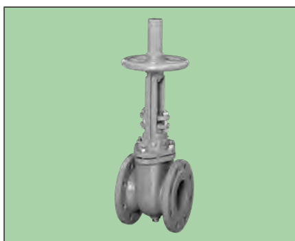
VAG KFS Keilflachschieber mit außenliegender Spindel Abwasser PN 1/1,6/2,5/4/6/10 - DN 50...1200 metallischdichtend - kurze Baulänge - mit Handrad
