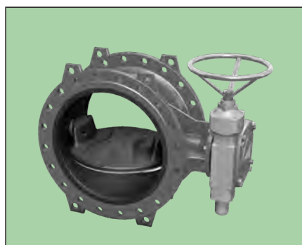
VAG EKN® H400 Absperrklappe Seewasser, Minenwasser PN 10/16/25 - DN 150...1200 Gummierte Ausführung Epoxid
