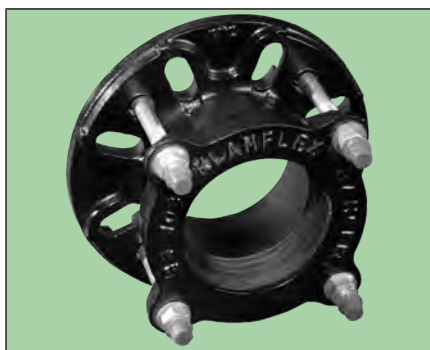
VAG VARIplus-RFA Flanschadapter Wasser, Abwasser, Seewasser PN 10/16 - DN 50...600 für verschiedene Rohraußendurchmesser
