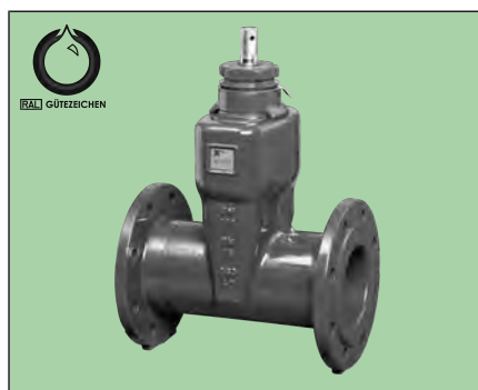
VAG BETA® 200 Absperrschieber Wasser PN 10/16 - DN 40...300 weichdichtend - lange Baulänge - Epoxid
