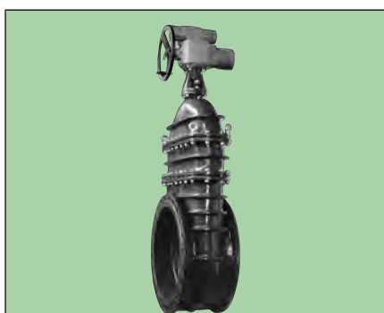
VAG KFS Keilflachschieber mit innenliegender Spindel Abwasser PN 1/1,6/2,5/4/6/10 - DN 80...1200 metallischdichtend - kurze Baulänge - mit Elektroantrieb
