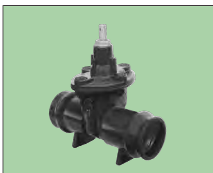
VAG BETA® 300 Absperrschieber mit Muffenanschluss Wasser PN 16 - DN 50...200 weichdichtend - SANS 664:2009 PE- / PVC-Rohr
