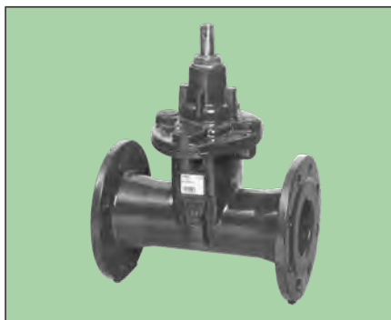
VAG BETA® 300 Absperrschieber Gulf Ausführung Wasser PN 16 - DN 50...500 weichdichtend - nach BS 5163 Typ A
