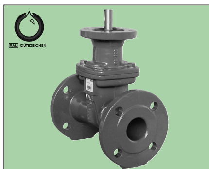
VAG BETA® 300 Absperrschieber vorbereitet für Elektroantrieb Wasser, Abwasser, Seewasser PN 10/16 - DN 40...600 weichdichtend - lange Baulänge
