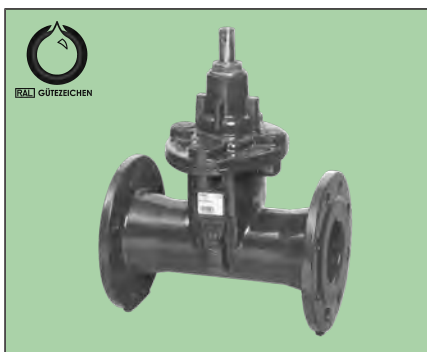
VAG BETA® 300 Absperrschieber Abwasser PN 10/16 - DN 40...600 weichdichtend - lange Baulänge
