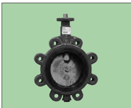
VAG CEREX® 300-L Absperrklappe Gas PN 10/16 - DN 50...300 Klappenscheibe Edelstahl - Lug-Type
