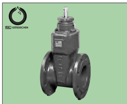
VAG BETA® 200 Absperrschieber Wasser PN 10/16 - DN 40...300 weichdichtend - kurze Baulänge - Epoxid
